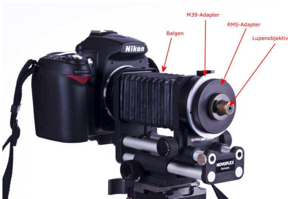
Lupenobjektiv mit RMS Adapter und M39 Adapter am Balgen montiert.
